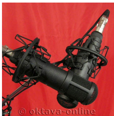
Montaje de grabación de dos micrófonos de condensador Oktava Mk319 en X-Y
