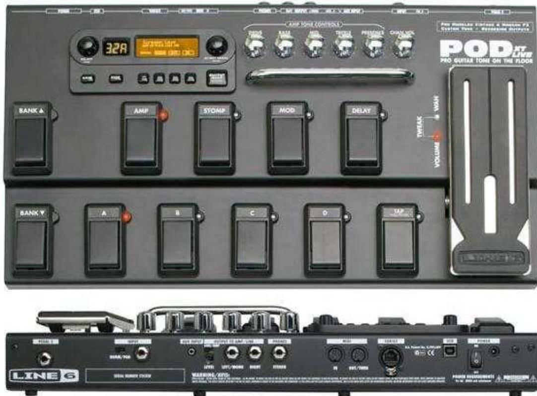
Figura 11. Procesador *pod XT Live* utilizado para generar la emulación de amplificador de guitarra.
