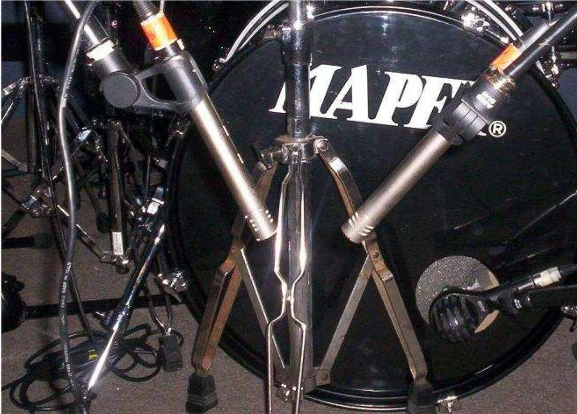
Figura 10. Micrófonos *AKG C451* usados para grabar el sonido de ambiente.
