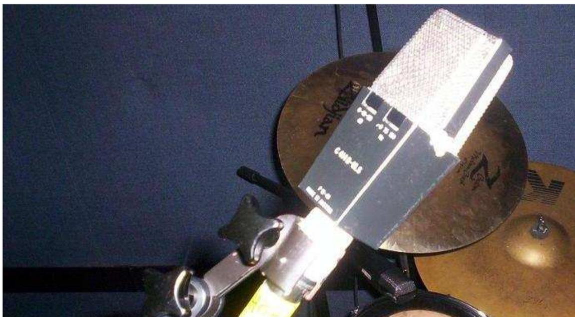
Figura 9. Micrófono AKG C 414 utilizado como *Over Head*.
