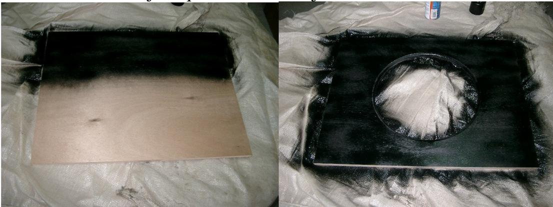
Para la conexión del altavoz pedí a Amptek un Switchcraft y para insertarlo en la madera busqué una chapa cuadrada para que me sirviera de soporte, le hice el agujero del Switchcraft y los cuatro pequeños para atornillarla a la tabla, una manita de pintura negra y a atornillar, previamente, claro, hay que hacer una agujero a la tabla para conectar el altavoz al Switchcraft, con una broca de pala, de 25mm es suficiente.
