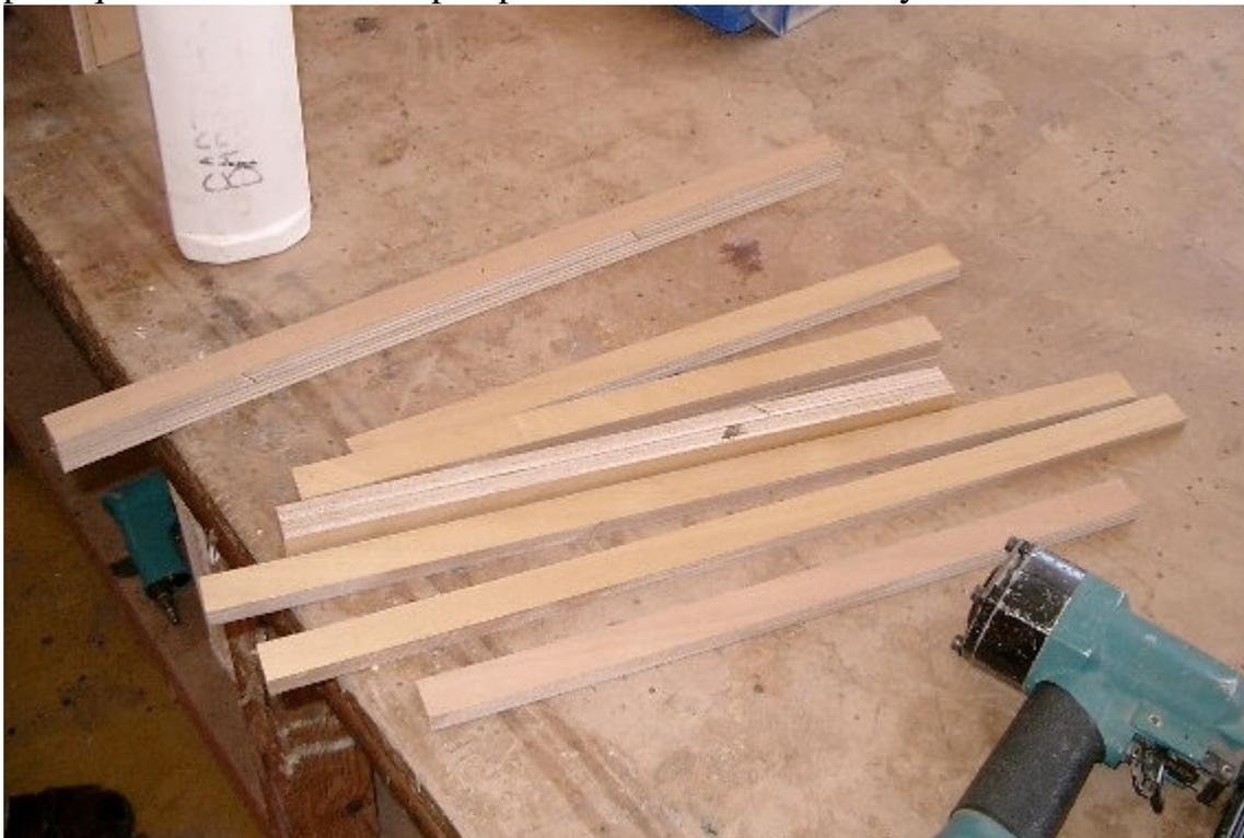
estos listones se colocan a modo de marco interior, y pondremos dos superiores y dos inferiores en la parte delantera (donde irá clavada la madera del altavoz por dentro) y solo un superior e inferior en la parte posterior, el motivo de poner solo dos atrás es para que después no tengamos problemas al meter y sacar la madera del altavoz.
