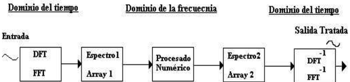
**Figura 55. Esquema para el procesado en el dominio de la frecuencia en un DSP.**
